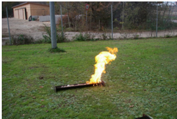
Abb. 8: Anfänglich starker Abbrand, seitlich der Wanne sind vereinzelt Funken zu sehen
