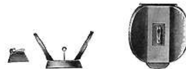
Durchbohrtes Perlkorn mit Silberlot
