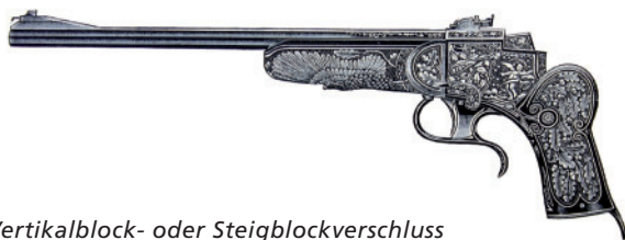
Vertikalblock- oder Steigblockverschluss
